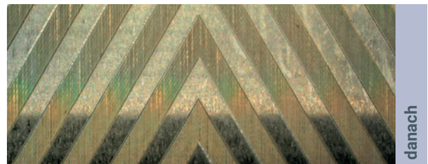
Elektronikindustrie: Leiterplatten-Laserstrukturierung – Entfernung von Laserschmauchspuren
