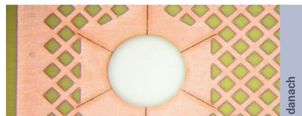
Elektronikindustrie: Leiterplatten-Laserstrukturierung – Entfernung von Laserschmauchspuren
