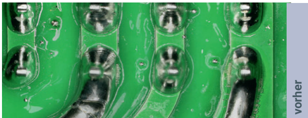
Elektronikindustrie: Leiterplatten – Entfernung von Löt- und Flussmittelrückständen
