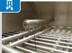
Hauptreinigungskammer mit Spritzdüsen
