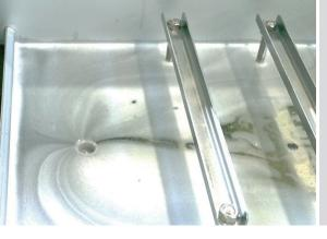
Die RTG Hydraulikeinheit saugt aufschwimmende Öle und Partikel im DPS 120 Koaleszenz-Ölabscheider ab.
