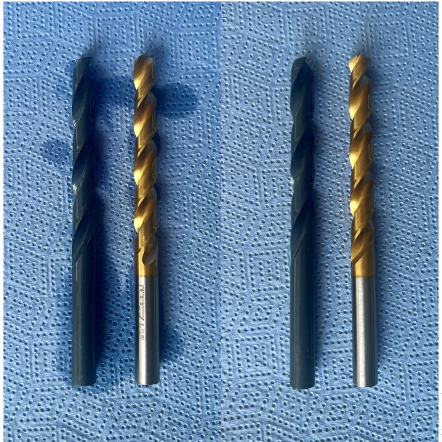
Die revolutionäre OSSBERGER 1 µm Dünnschicht-Technologie reduziert den Ölauftrag und -verbrauch für der Konservierung eines HSS-Bohrers von 25,7 g/m 2 (linkes Bild) auf 0,8 g/m 2 (rechtes Bild). Die bisher benötigte 30-minütige Abtropfzeit entfällt vollständig.
