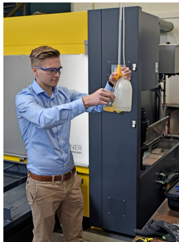
Daniel Leeb, bei der MAP PAMMINGER GMBH verantwortlich für die kleineren Reinigungsanlagen, überprüft mit dem WIGOL-Titrationskoffer die Reiniger-Konzentration.
